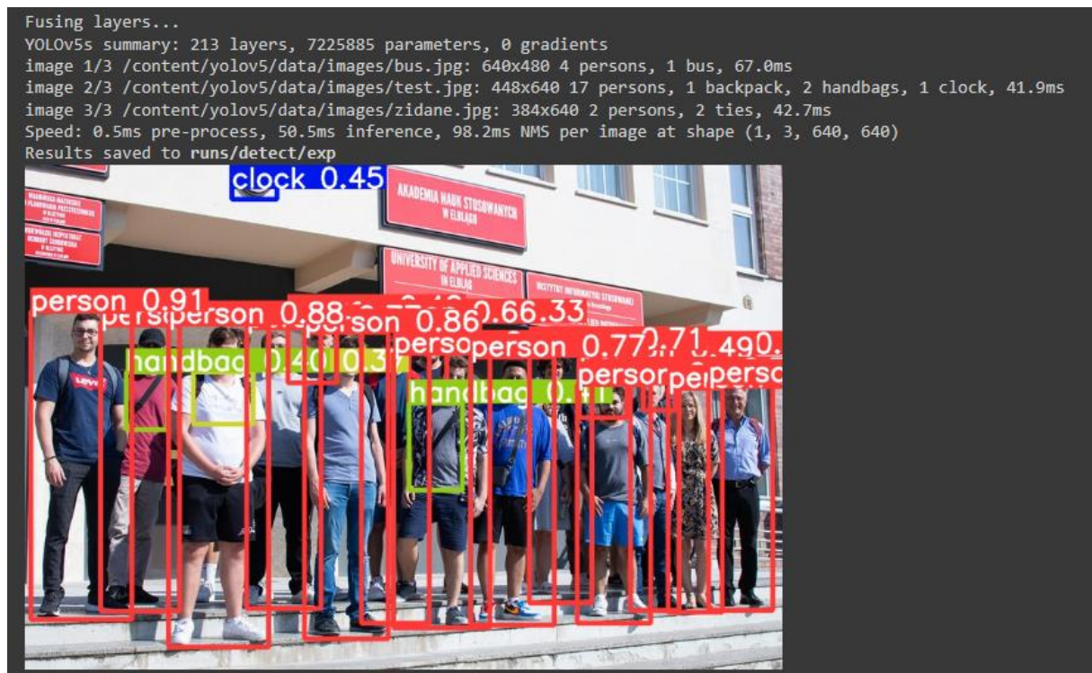
Rys.1.2. – Zdjęcie otrzymane po użyciu metody „YoloV5” z parametrem –conf 0.25
